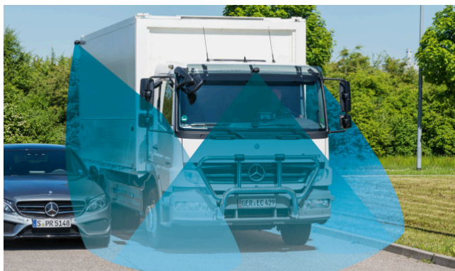
Das modulare SurroundView-System bringt Umgebungsaufnahmen auf einem Monitor zusammen und ermöglicht so das Einsehen von Totwinkeln.
