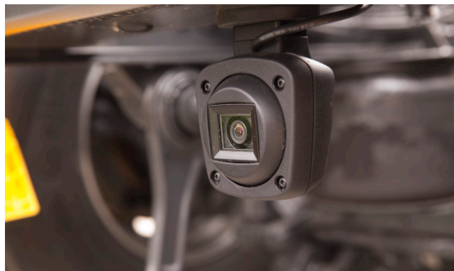
Rundumblick für den Fahrer: Das SurroundView-System kann auch den seitlichen Bereich des Fahrzeugs abdecken. Bis zu vier Kameras können an den Monitor angeschlossen werden.
